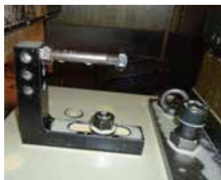
ノズル角度変更用治具例
